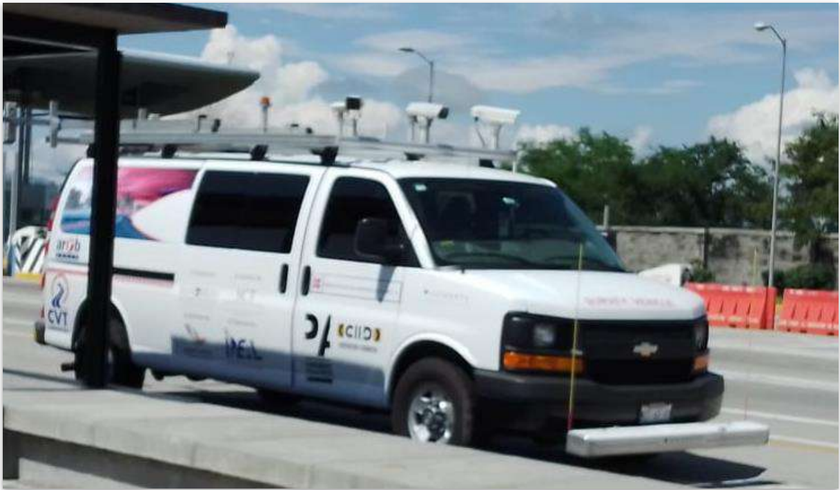
Figura 2. Vehículo certificado por iRAP para levantamiento de imágenes georreferenciadas
