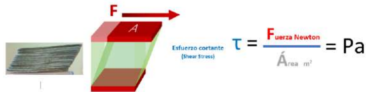
Figura 4. Explicación del esfuerzo cortante (Shear Stress) aplicado a el asfalto.
