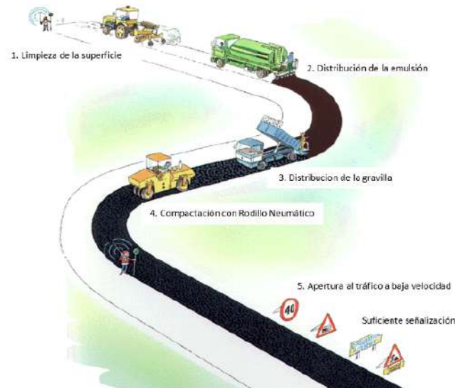
Figura 2. Etapas o pasos que deben de seguirse para la colocación de un riego de sello con gravilla
