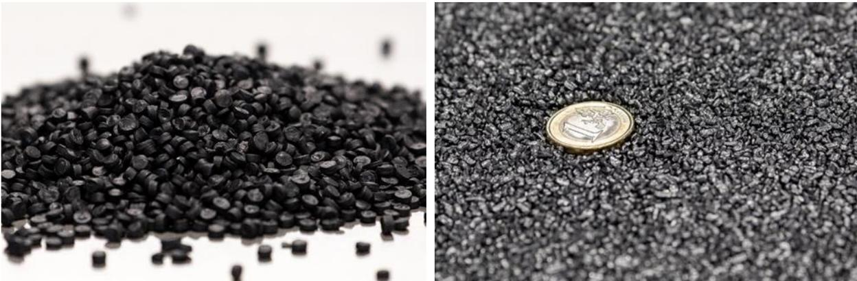
Figura 2. Nanoplaquetas de grafeno y compuesto polimérico (Gipave®)
