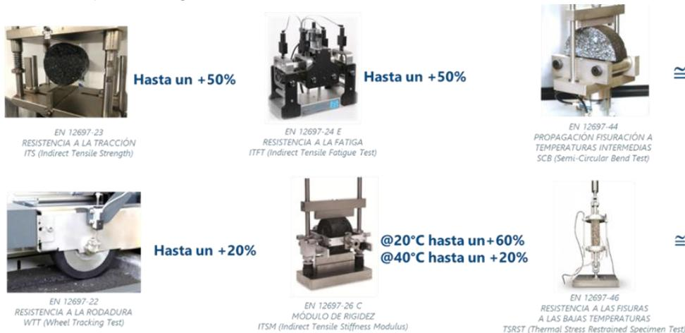
Figura 7. Rendimiento técnico de la mezcla asfáltica con supermodificador con grafeno y plásticos reciclados en comparación con las mezclas convencionales con PmB (valores obtenidos tras 6 años de investigación y tramos de prueba)
