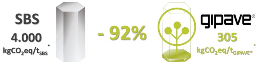
Figura 6. Huella de carbono de Gipave® vs SBS
