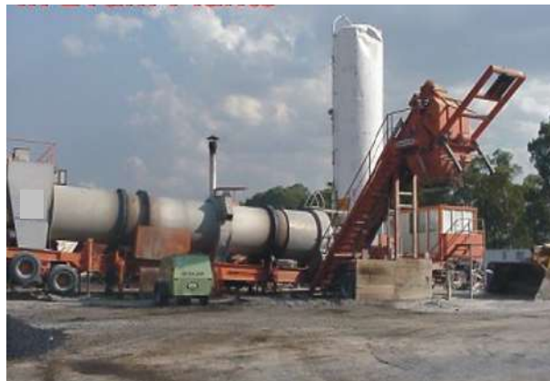
Figura 5. Planta de doble tambor con anillo de reciclado
