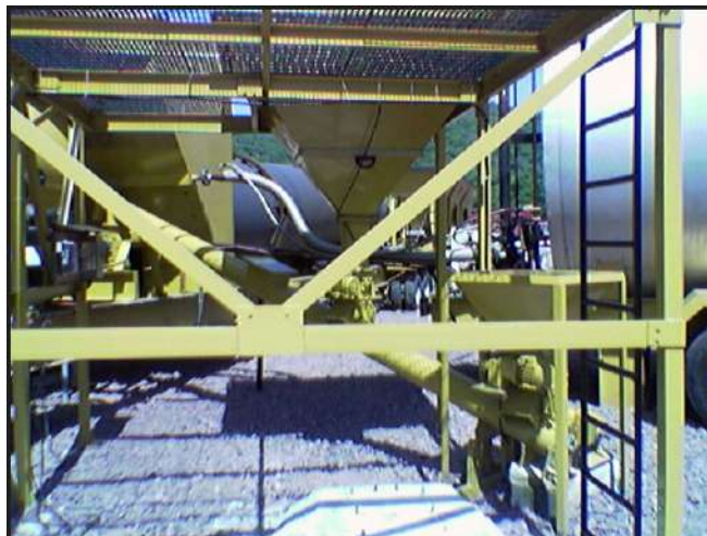
Figura 16. Primera Bazuca recibiendo Filler y Fibra para trasladarla a la segunda bazuca de entrada al tambor
