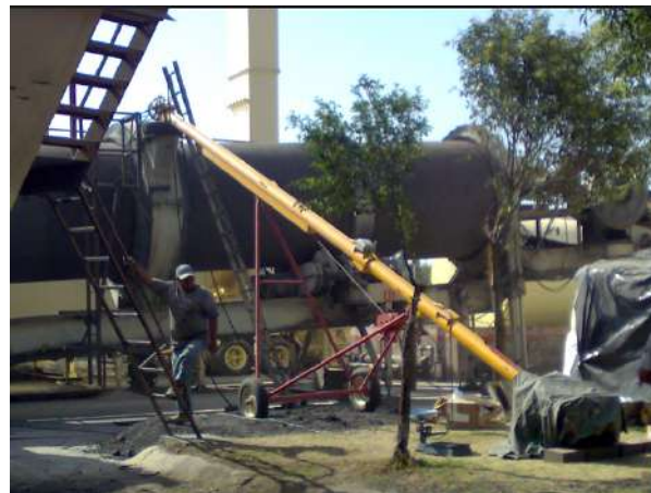
Figura 7. Alimentación inapropiada de fibra en planta doble tambor
