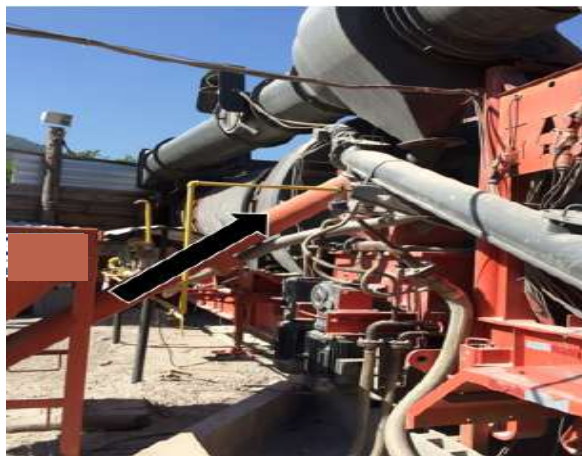
Figura 12. Vista perfil de bazucas alimentando filler y fibra al pullmix
