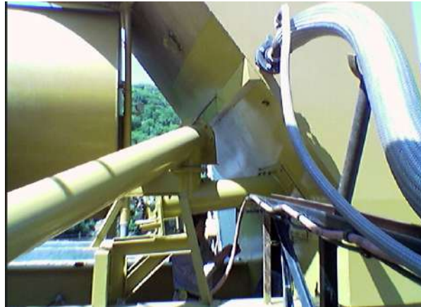
Figura 17. Conexión de primera bazuca a la segunda, que entra al tambor para incorporar filler y fibra
