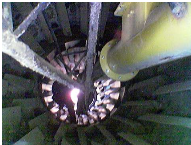
Figura 17. Conexión de primera bazuca a la segunda, que entra al tambor para incorporar filler y fibra
