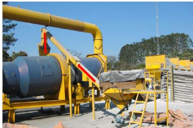
Figura 8. Alimentación adecuada de Filler y Fibra en planta con anillo de RAP
