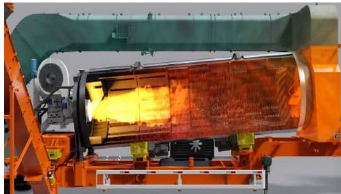
Figura 10. Esquema de calentamiento interno en tambor corto con mezclado en pullmix
