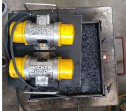
Figura. 3. Compactador de losas de mezcla asfáltica.
